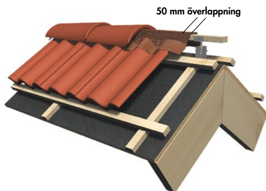
Bild 2. Bender Nock- och Valmtättningsrulle monterad.
